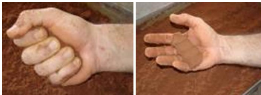
Teste expedito para verificação da umidade adequada de compactação.
