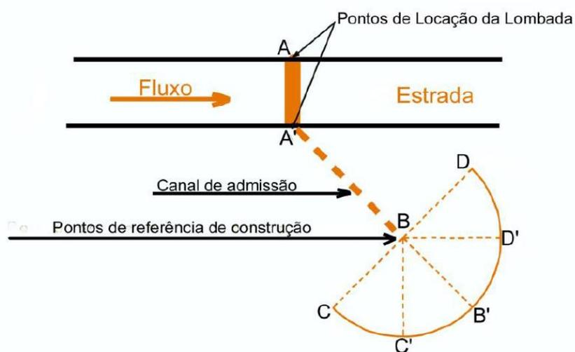
Mantendo o comprimento C – D, com o ponto B fixo, rotacionar a bacia de modo que os pontos C e D ocupem a mesma cota no terreno. Posteriormente localizar os pontos B', C' e D', mantendo o mesmo raio BC ou BD, sendo que nos pontos B', C' e D' deve-se deixar uma borda livre de no mínimo 30 cm acima da cota original.
