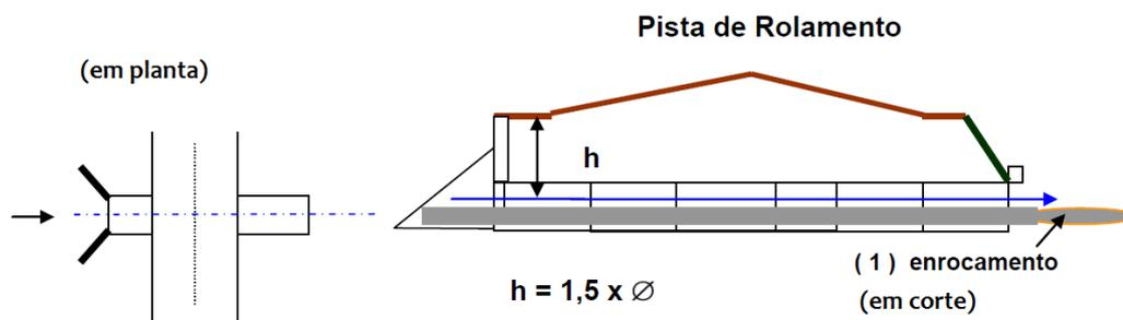
Muros de Ala e caixas de captação para tubulações: em alvenaria de tijolos comuns, e estrutura de concreto armado, conforme detalhe em projeto.
