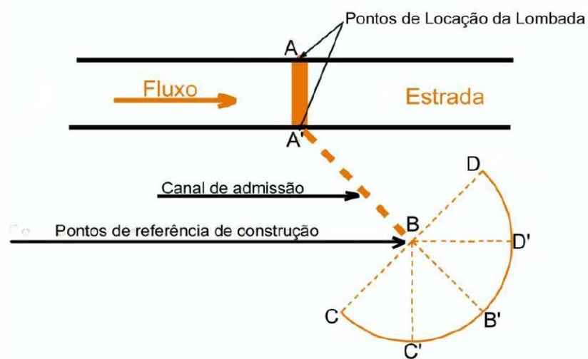
Mantendo o comprimento C – D, com o ponto B fixo, rotacionar a bacia de modo que os pontos C e D ocupem a mesma cota no terreno. Posteriormente local os pontos B', C' e D', mantendo o mesmo raio BC ou BD, sendo que nos pontos B', C' e D' deve-se deixar uma borda livre de no mínimo 30 cm acima da cota original.
