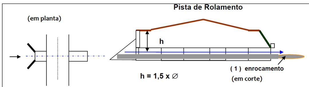
**Figura 5** - Esquema representativo da instalação de tubulação de fluxo transversal
