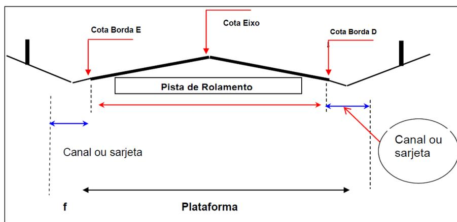
**Figura 2** – Componentes da seção transversal da estrada
