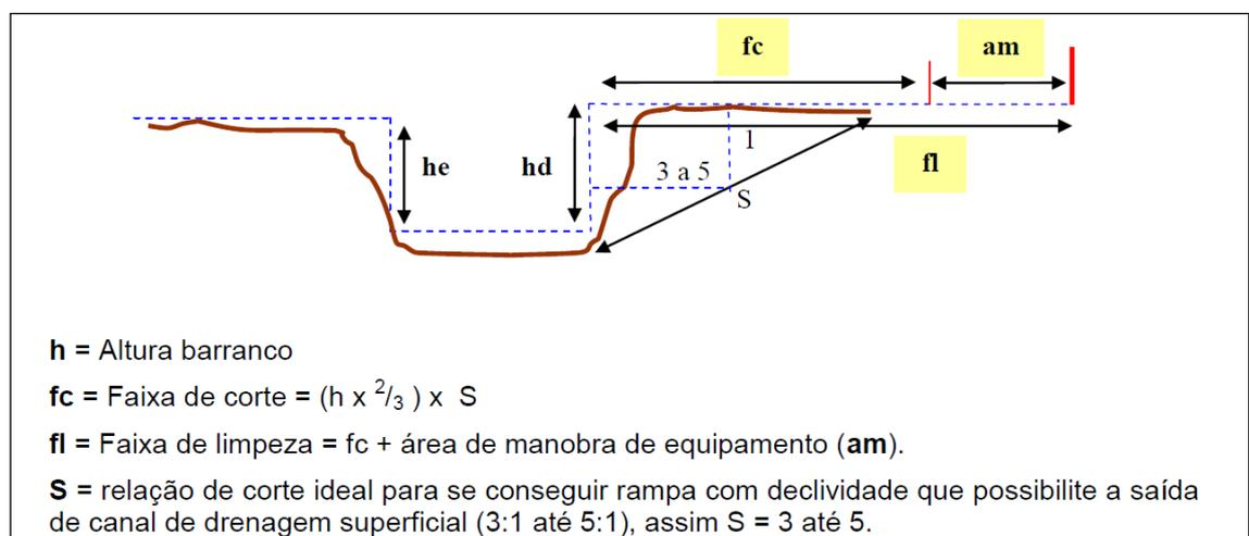
**Figura 1** – Seção em corte transversal da estrada e do barranco
