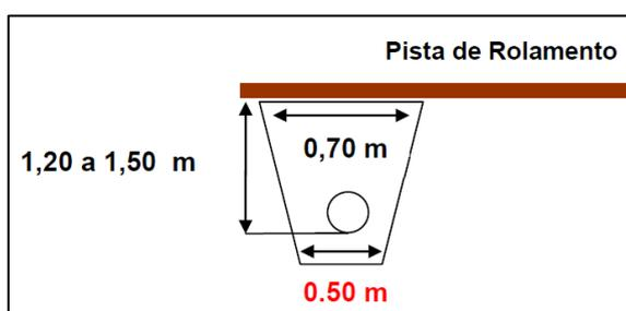
**Figura 4** - Esquema de Dreno profundo em situação transversal à pista.
