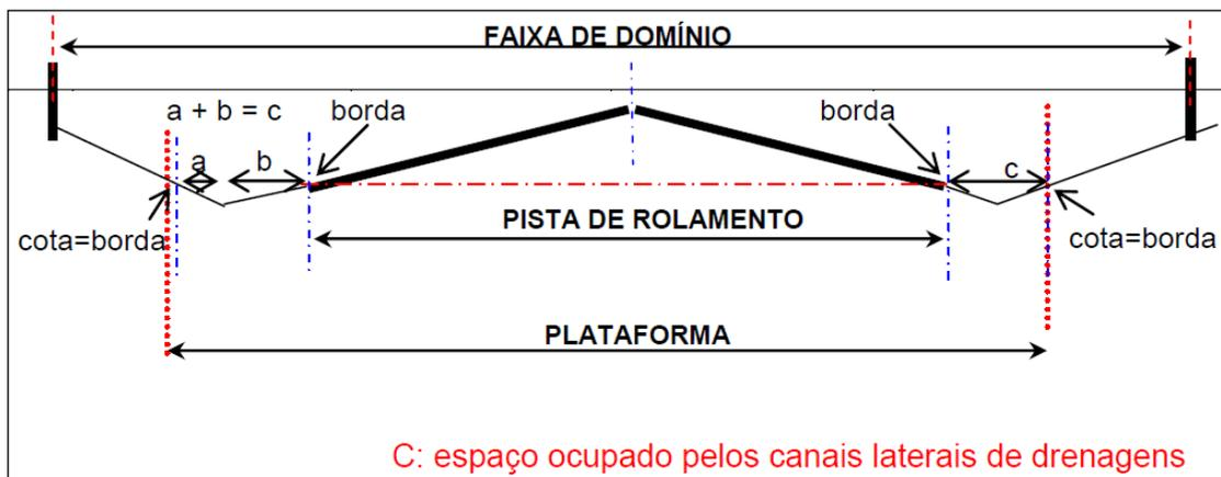
**Figura 6** – Partes constituintes da seção da plataforma
