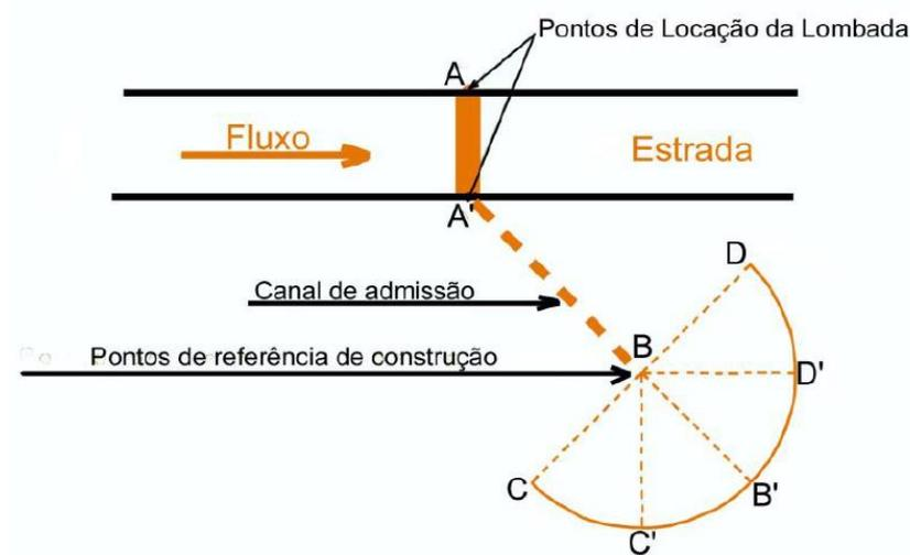
Mantendo o comprimento C – D, com o ponto B fixo, rotacionar a bacia de modo que os pontos C e D ocupem a mesma cota no terreno. Posteriormente locar os pontos B', C' e D', mantendo o mesmo raio BC ou BD, sendo que nos pontos B', C' e D' deve-se deixar uma borda livre de no mínimo 30 cm acima da cota original.
